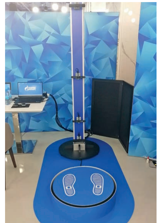
Виртуальная примерочная позволяет оперативно и точно определить размеры одежды работников
