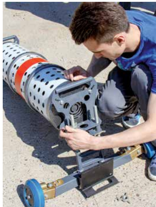
Сборка и настройка самоходного дефектоскопа занимают не более 30 минут
