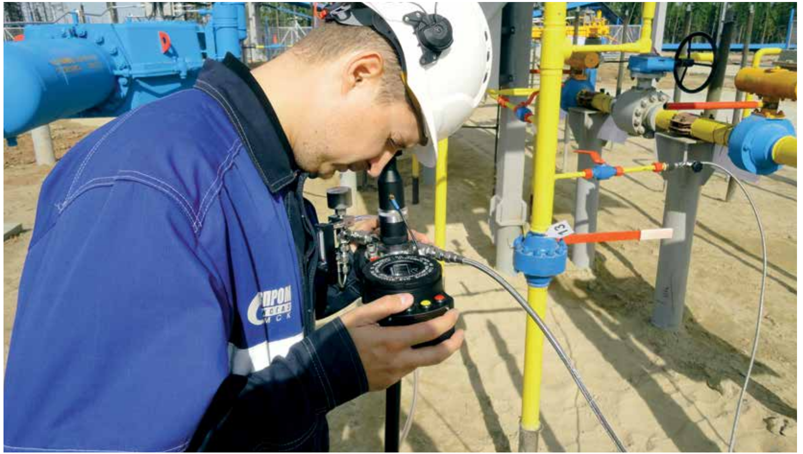
Инженер-химик Томского ЛПУМГ Сергей Тимофеев с помощью гигрометра определяет точку росы
