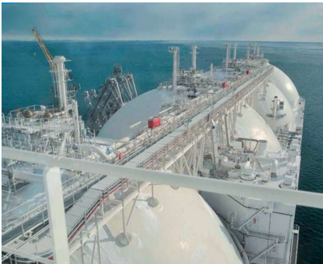
Транспортировка сжиженного природного газа осуществляется специальными судами – газовозами, способными перевозить сотни тысяч тонн СПГ
